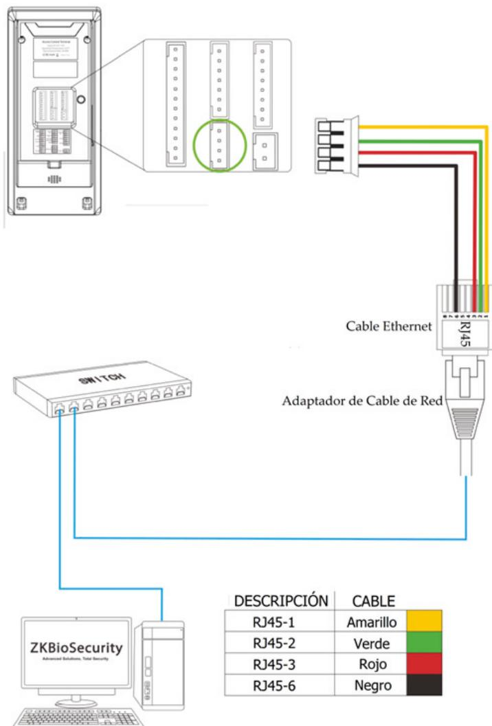
**Nota:** El dispositivo puede conectarse directamente al PC utilizando el cable Ethernet.
